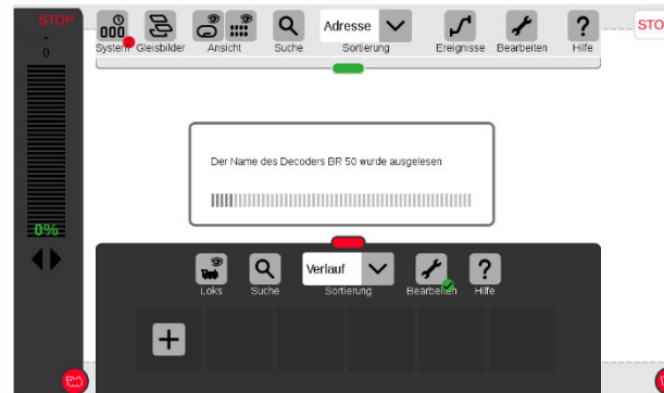
Der Decoder (Lok) ist nun am Gleis, die Anmeldung beginnt
