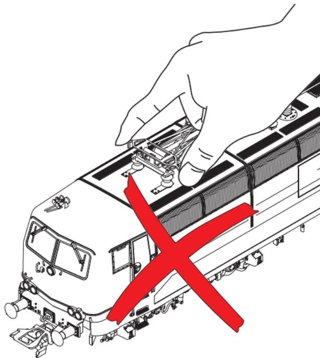
**Hinweis:** Vor dem ersten Betrieb der Lok müssen die Pantographen von Hand entriegelt werden. Der Pantograph federt selbst in die obere Stellung hoch.
