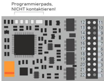
**MX676VD MTC-Decoder nach ZIMO Konvention umschaltbar zu MTC-Decoder nach Railcommunity-Norm**
