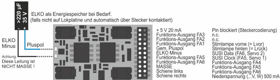
Anschlussplan MX687D, VD, WD Unterseite
