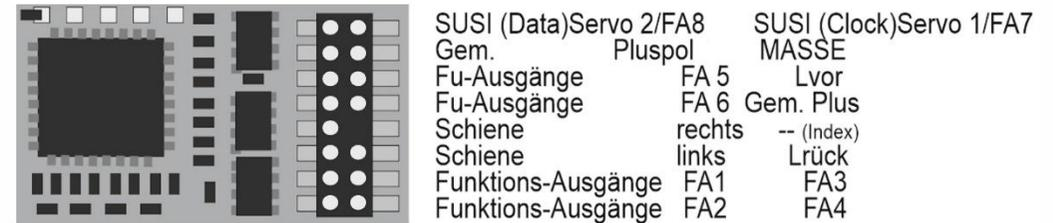
Anschlussplan MX686 (bis 2012) Oberseite bedrahtet (auf Basis von MX631-Serie)
