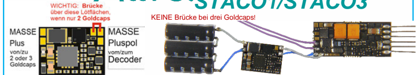
STACO1: 10 x 7,3 x 2 mm (CAD 2:1 vergrößert) STACO1 (Mitte) an Miniatur-Sound-Decoder MS490N und 3 Mini-Goldcaps in Serie geschaltet (Maßstab 1:1)
