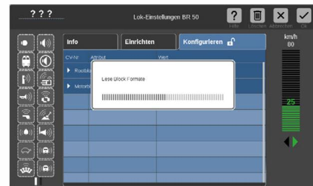
... die „Blöcke“ (das sind die Gruppen von Konfigurationsparametern) vom Decoder ausgelesen und geöffnet (Rootblock, Motorblock, Formate, Sound, usw.).
