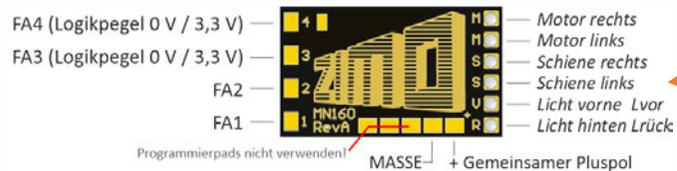
Vorsicht beim Löten der Lötstellen für umseitige Kabel bzw. Stifte
