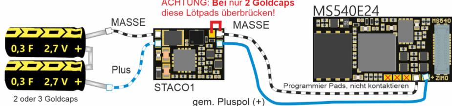
Die STACO-Platines enthalten einen Step-up-Spannungswandler, der die Goldcaps von ihrem vollem Ladezustand (8 V bei 3 Stk.; 5,2 V bei 2) bis zu ihrer fast vollständigen Entladung (2 V) aussaugt und eine konstante Spannung von 10 V abgibt. Das reicht zum Fahren und zur unterbrechungsfreien Versorgung des Sound-Verstärkers (läuft auf 5 V) ohne Lautstärkeverlust.
