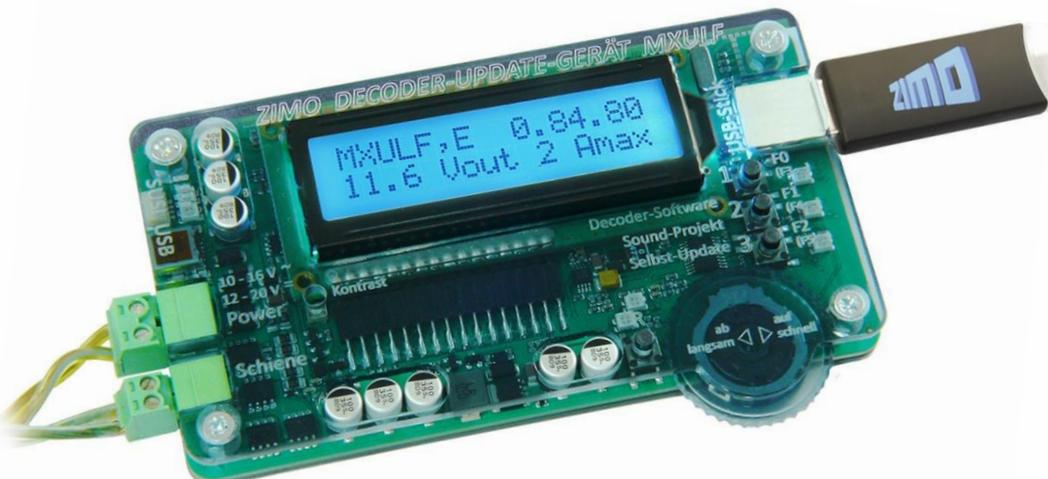
Kurzbeschreibung zum Laden neuer Software-Versionen (Update) und Sound-Projekte in einzelne MS-Decoder. Volle Beschreibung, z.B. von Update- und Ladeprozeduren für mehrere Decoder gleichzeitig oder Fahrbetrieb mit MXULF, siehe Betriebsanleitung MXULF.
