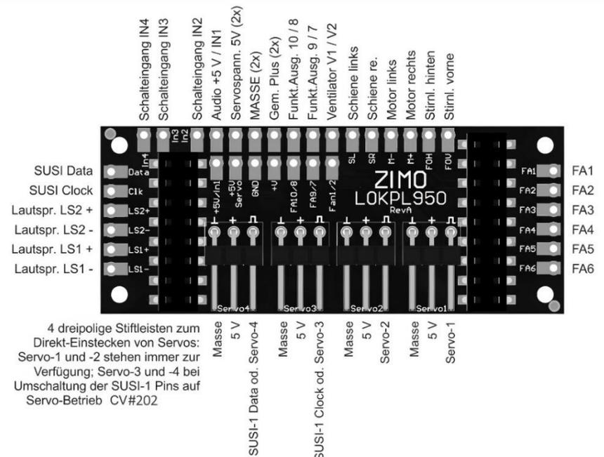
**Servo-Steuerleitungen an SUSI-Pins**
