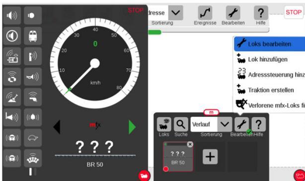
„Schraubenschlüssel“-Buttons drücken und „Loks bearbeiten“ anwählen. Ein grüner Haken erscheint am Schraubenschlüssel. Danach auf die Lok tippen um die „Lok Einstellungen...“ zu öffnen.
