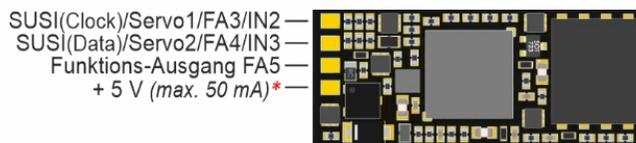
\* Abnahme von stabilisierten + 5 V möglich, max. 50 mA
