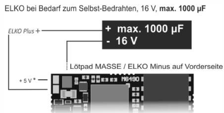
\* Abnahme von stabilisierten +5 V möglich, max. 50 mA
