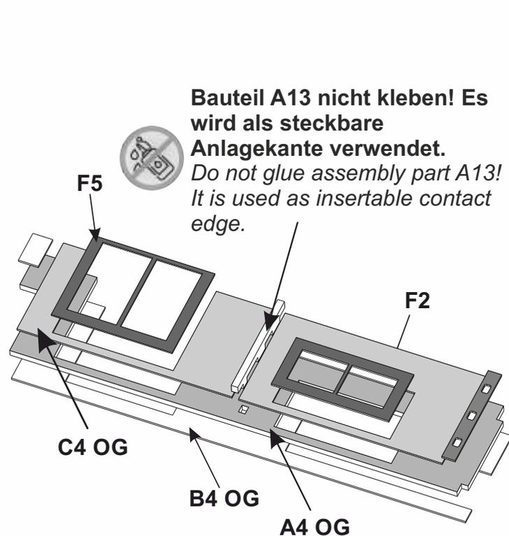
**Bauteil A13 nicht kleben! Es wird als steckbare Anlagekante verwendet.**
