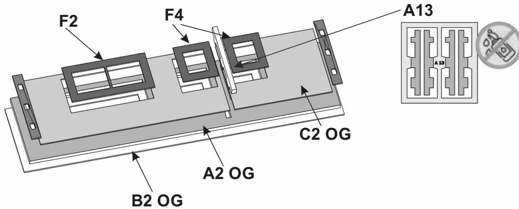
**Bauteil A13 nicht kleben! Es wird als steckbare Anlagekante verwendet.**
