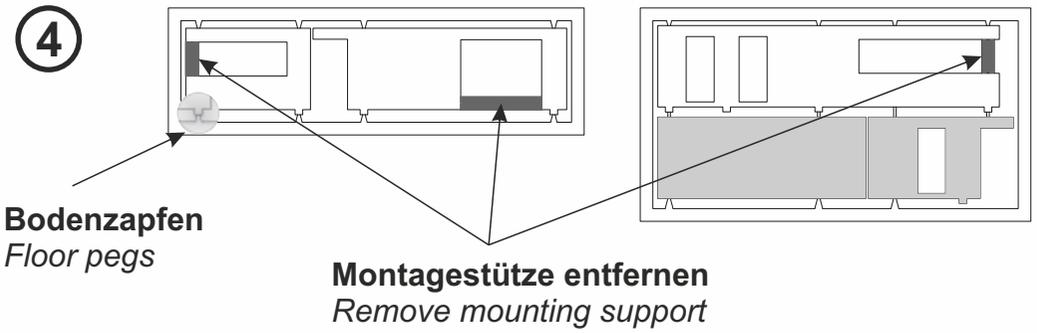
**Montagestützen nicht mit Klebstoff bestreichen. Nach der Verklebung der Fassade sind die Montagestützen zu entfernen.**
