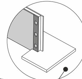
**Die Montagehilfe kann bei der Positionierung der Wände zur Hilfe genommen werden.**
