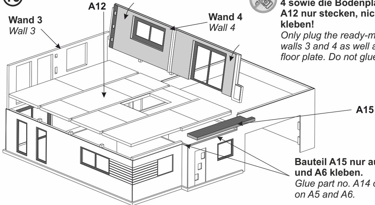
Die fertigen Wände 3 und 4 sowie die Bodenplatte A12 nur stecken, nicht kleben!
