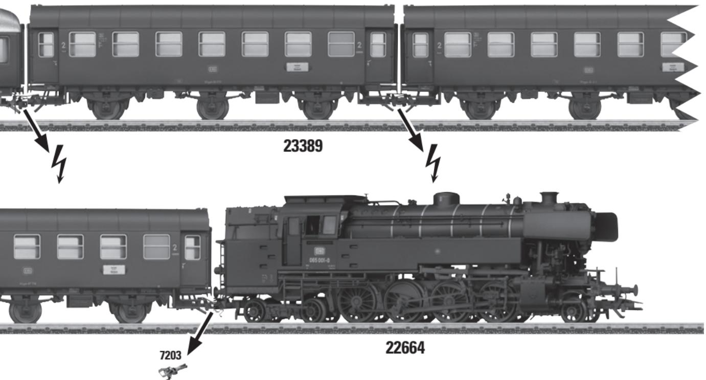
**⚡** = stromführende Kupplung; current-conducting couplers; Accouplements conducteurs; Spannunggeleidende koppelingen;
