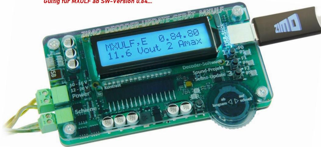
Kurzbeschreibung zum Laden neuer Software-Versionen (Update) und Sound-Projekte in einzelne MS-Decoder. Volle Beschreibung, z.B. von Update- und Ladeverfahren für mehrere Decoder gleichzeitig oder Fahrbetrieb mit MXULF, siehe Betriebsanleitung MXULF.
