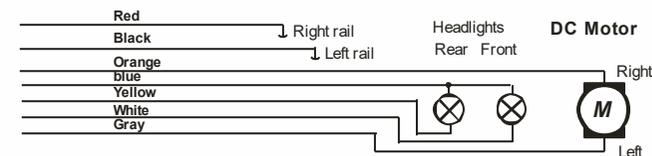
Wie im Schaltplan angeschlossene Scheinwerfer sind richtungsabhängig und werden mit der Taste F0 ein- und ausgeschaltet. Bei entsprechender Verwendung der "Funktionszuordnung" - CVs #33, #34, #35, ... - ist es auch möglich, die Scheinwerfer unabhängig voneinander mit F0 und F1 zu steuern.
