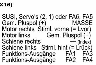
MX630P16 besitzt eine 16-polige „PluX“-Stiftleiste (davon 15 Pins tatsächlich vorhanden; 1 Indexposition); er kann in Fahrzeuge mit 16-poliger PluX-Buchsenleiste eingesetzt werden, aber auch in solche mit 22-poliger, entsprechend der Abbildung links (braune Zone = 16-polig).
