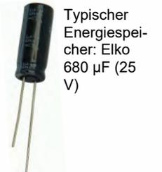
Die erlaubte Kapazität des angeschlossenen Kondensators ist im Allgemeinen beschränkt auf **5000  $\mu\text{F}$** ; der SuperCap mit 6800  $\mu\text{F}$  (siehe „PluX-artige Decoder“) kann NICHT verwendet werden, weil dessen Spannungsfestigkeit mit 15 V nicht ausreicht (weniger wegen seiner Kapazität). AUSNAHME: wenn die Fahrspannung 16 V sicher NIE überschreitet, wäre der Einsatz des SuperCaps unter diesen Umständen möglich!
