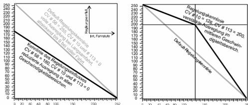
Durch CV #58 wird das generelle Ausmaß der Ausregelung von "keine Regelung" (Wert „0“, wie ein ungeregelter Decoder) bis volle Regelung (Wert „255“) eingestellt; sinnvolle Werte sind zwischen "100" und "200".
