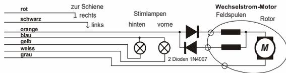
Meistens werden Wechselstrom-Loks über Mittelleiter versorgt; dies hat jedoch mit der Anschlussweise des Motors an sich nichts zu tun. Das obige Schema gilt also sowohl für Schienen im Zweileitersystem als auch im Dreileitersystem (statt "Schiene rechts" und "Schiene links" hieße es dann Außen- und Mittelleiter).
