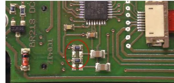
Platine mit den „gefährlichen“ Null-Ohm-Widerständen („000“); die Platine kann im Einzelfall anders aussehen; in dieser Form ist als die Inbetriebnahme mit MX631C, MX632C, ... nicht erlaubt!
