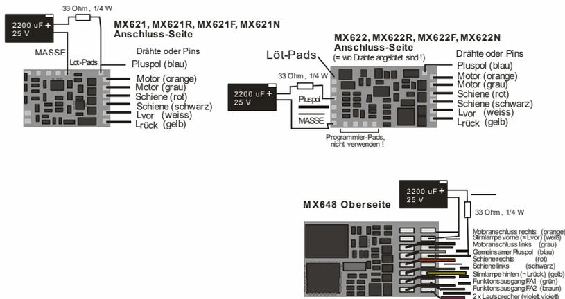
**ACHTUNG - NUR FÜR KLEINEN STROM:** Der Widerstand reduziert natürlich auch die Wirksamkeit des Energiespeichers, weil durch den Spannungsabfall der verwertbare Entladestrom, der in den Decoder fließen kann, auf etwa 200 mA begrenzt wird (und auch dabei bereits ca. 6 V
