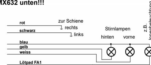
**Verwendung der "Logikpegel" (unverstärkten) Funktionsausgänge:**
