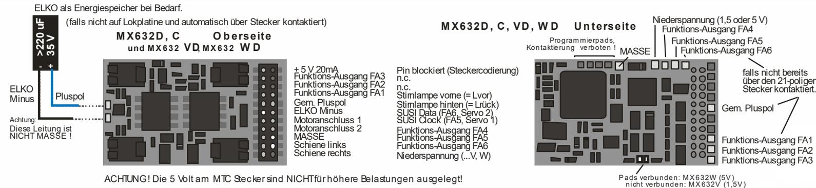
„C“-Typen unterscheiden sich von „D“-Typen durch die Ausführung der Fu-Ausgänge F3 und F4:
