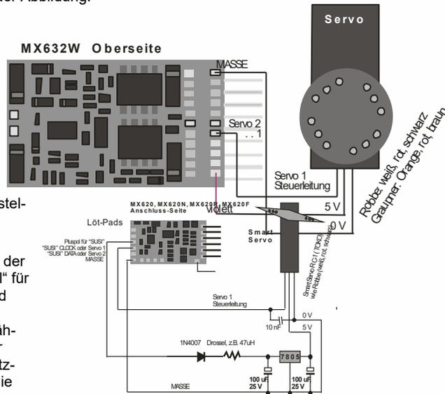
**MX640, MX642 - Anschluss von Servo-Antrieben und SmartServo:**
