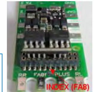
Zu empfehlen wäre daher besser die Verwendung eines MX633P22 als Nicht-Sound-Alternative zum MX630P16, der eben eine direkte Energiespeicher-Anschaltung besitzt (sogar auch für GoldCap-Module geeignet).
