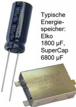
Die erlaubte Kapazität des angeschlossenen Kondensators ist im Allgemeinen beschränkt auf **5000  $\mu\text{F}$** , leichte Überschreitung (z.B. der abgebildete SuperCap mit **6800  $\mu\text{F}$**  aus dem ZIMO Programm) möglich.
