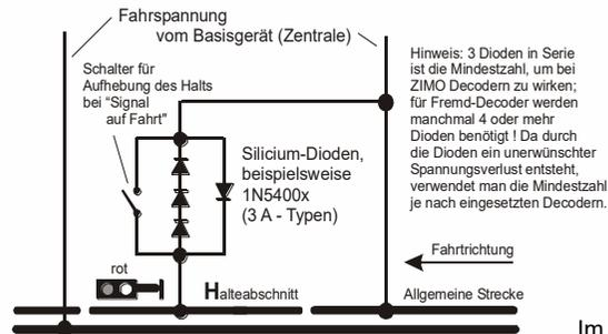
Normalerweise wird der Halteabschnitt über 3 bis 5 Silizium-Dioden in Serie und dazu parallel-geschaltet eine **Schottky-Diode in Gegenrichtung** angeschlossen. Der unterschiedliche Spannungs-abfall erzeugt eine Asymmetrie von ca. 1 bis 2 V. Die Einbaurichtung der Dioden bestimmt die Richtung der Asymmetrie und damit die Fahrtrichtung, in welcher der Signalstopp eintreten soll.
