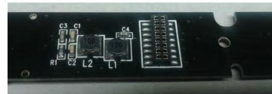
**Abhilfe:** Der „schädliche“ Kondensator auf der PIKO-Lokplatine ist üblicherweise mit „C4“ gekennzeichnet, dieser muss entfernt werden. Dazu muss normalerweise die Lokplatine entnommen werden, weil der Kondensator auf der Unterseite bestückt ist.
