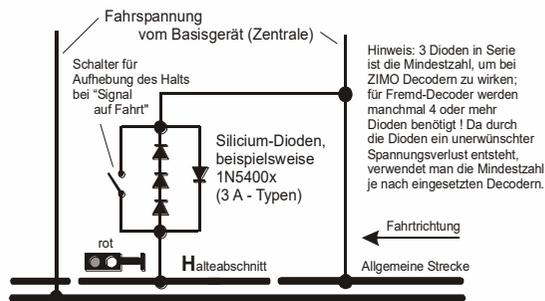
Das „asymmetrische DCC-Signal“ ist eine alternative Methode, Züge in Halteabschnitten (z. B. vor dem roten Signal) zu stoppen. Dazu genügt eine einfache Schaltung aus 4 oder 5 handelsüblichen Dioden.
