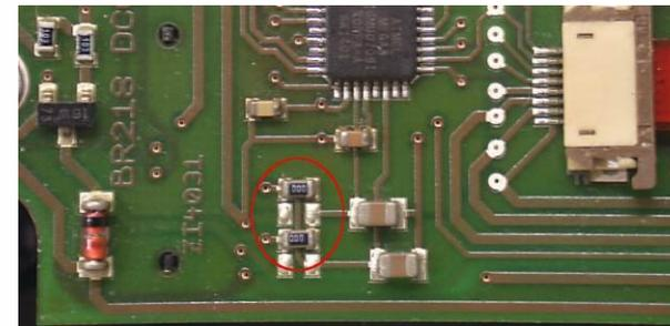
Platine mit den „gefährlichen“ Null-Ohm-Widerständen („000“); die Platine kann im Einzelfall anders aussehen; in dieser Form ist als die Inbetriebnahme mit MX631C, MX632C, ... nicht erlaubt!
