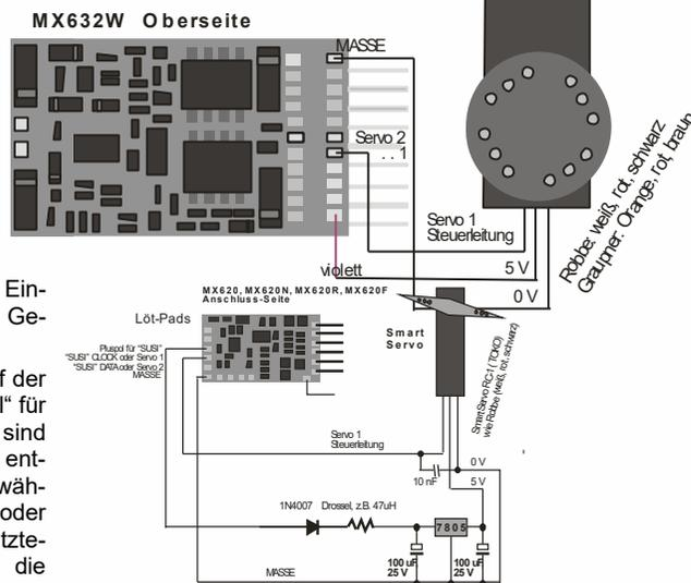
**MX640, MX642 - Anschluss von Servo-Antrieben und SmartServo:**
