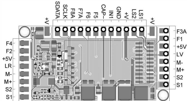
Ein **Energie-speicher** (ELKO oder GoldCap-Modul) wird zwischen **V+** und **CAP-** angeschlossen.
