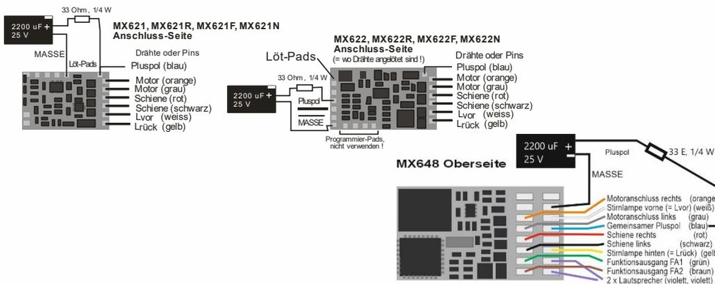
**ACHTUNG - NUR FÜR KLEINEN STROM:** Der Widerstand reduziert natürlich auch die Wirksamkeit des Energiespeichers, weil durch den Spannungsabfall der verwertbare Entladestrom, der in den Decoder fließen kann, auf etwa 200 mA begrenzt wird (und auch dabei bereits ca. 6 V „verloren gehen“). Für kleine Loks (insbesondere in N-Spur, aber auch TT oder H0 mit effizienten Motoren und ausschließlicher LED-Beleuchtung) kann diese Schaltung trotzdem sehr hilfreich sein.
