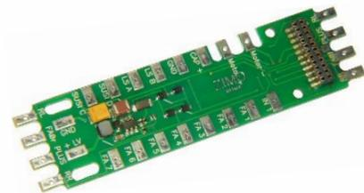
ADAPUS15 mit 1,5 V Niederspannung, 71 x 18 x 4 mm
