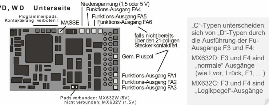
„C“-Typen unterscheiden sich von „D“-Typen durch die Ausführung der Fu-Ausgänge F3 und F4:
