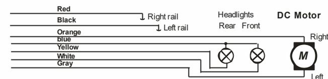
Wie im Schaltplan angeschlossene Scheinwerfer sind richtungsabhängig und werden mit der Taste F0 ein- und ausgeschaltet. Bei entsprechender Verwendung der "Funktionszuordnung" - CVs #33, #34, #35, ... - ist es auch möglich, die Scheinwerfer unabhängig voneinander mit F0 und F1 zu steuern.
