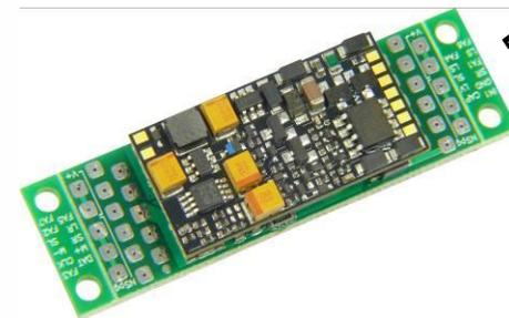
← **ADAPLU mit aufgestecktem MX645P22** ergibt einen „Sound-Decoder“ mit
