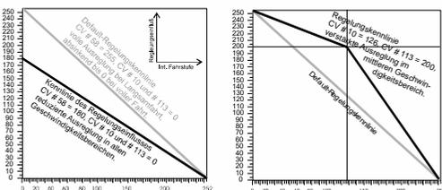
Durch CV #58 wird das generelle Ausmaß der Ausregelung von "keine Regelung" (Wert „0“, wie ein unregelter Decoder) bis volle Regelung (Wert „255“) eingestellt; sinnvolle Werte sind zwischen "100" und "200".
