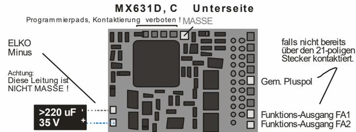
„C“-Typen unterscheiden sich von „D“-Typen durch die Ausführung der Fu-Ausgänge F3 und F4:
