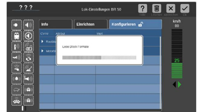
... die „Blöcke“ (das sind die Gruppen von Konfigurationsparametern) vom Decoder ausgelesen und geöffnet (Rootblock, Motorblock, Formate, Sound, usw.).
