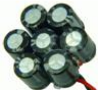
GoldCap-Module mit 7 GoldCaps (7 x 1F in Serie, also 140000µF / 17,5 V)
