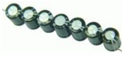
GoldCap-Module mit 7 GoldCaps (7 x 1F in Serie, also 140000µF / 17,5 V)
