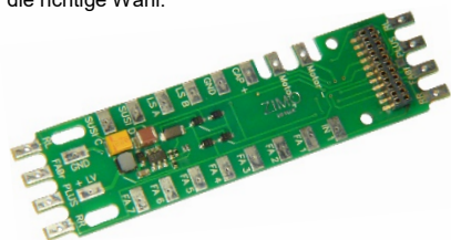
ADAPUS15 mit 1,5 V Niederspannung, 71 x 18 x 4 mm
