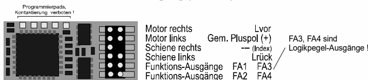
MX623 Oberseite Pad-Belegung (PluX-12)
