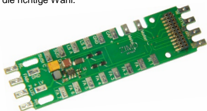
ADAPUS15 mit 1,5 V Niederspannung, 71 x 18 x 4 mm
