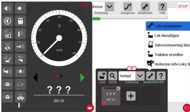
„Schraubenschlüssel“-Buttons drücken und „Loks bearbeiten“ anwählen. Ein grüner Haken erscheint am Schraubenschlüssel. Danach auf die Lok tippen um die „Lok Einstellungen...“ zu öffnen.
