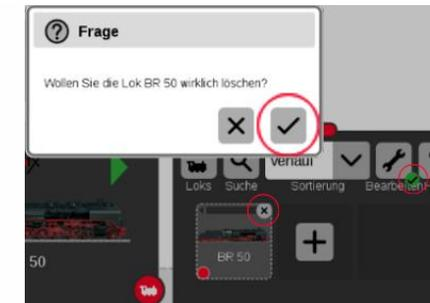
Nach Eingabe des neuen Wertes, resettet der Decoder automatisch und ist damit bereit zur Anmeldung als Diesellok BR 211. Die „alte“ Lok muss jedoch vorher noch gelöscht werden.
