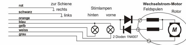
Meistens werden Wechselstrom-Loks über Mittelleiter versorgt; dies hat jedoch mit der Anschlussweise des Motors an sich nichts zu tun. Das obige Schema gilt also sowohl für Schienen im Zweileitersystem als auch im Dreileitersystem (statt "Schiene rechts" und "links", dann Außen- und Mittelleiter).
