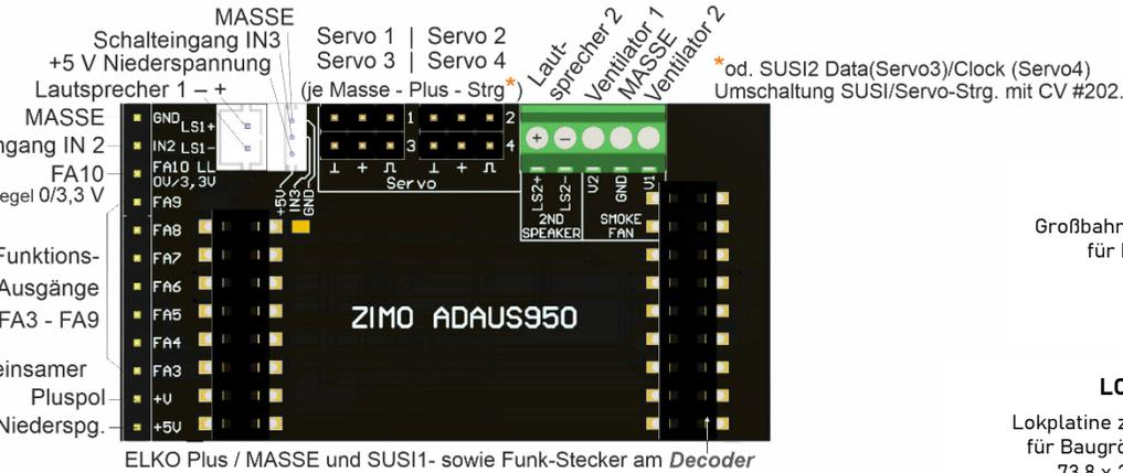
**Anschluss Rauchgenerator an LOKPL950K mit MS950**
