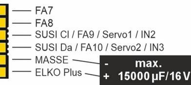
Elkos oder Tantals bei Bedarf zum Selbstbedrahten, 16V, max. 15000 µF
