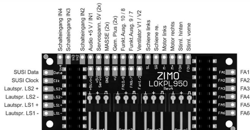
4 dreipolige Stiftleisten zum Direkt-Einstecken von Servos: Servo-1 und -2 stehen immer zur Verfügung; Servo-3 und -4 bei Umschaltung der SUSI-1 Pins auf Servo-Betrieb CV#202
