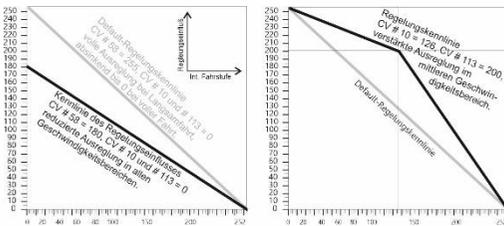
Durch CV #58 wird das generelle Ausmaß der Ausregelung von "keine Regelung" (Wert „0“, wie ein unregelmäßiger Decoder) bis volle Regelung (Wert „255“) eingestellt; sinnvolle Werte sind zwischen "100" und "200".
