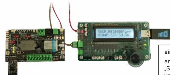
ein „21MTC“-Decoder zum Sound-Laden an **MSTAPK2**; Verbindung zu **MXULF** über „**SUSI**“-Kabel, aber **KEIN** Kabel „**Schiene**“ von **MXULF** zu **TAP**
