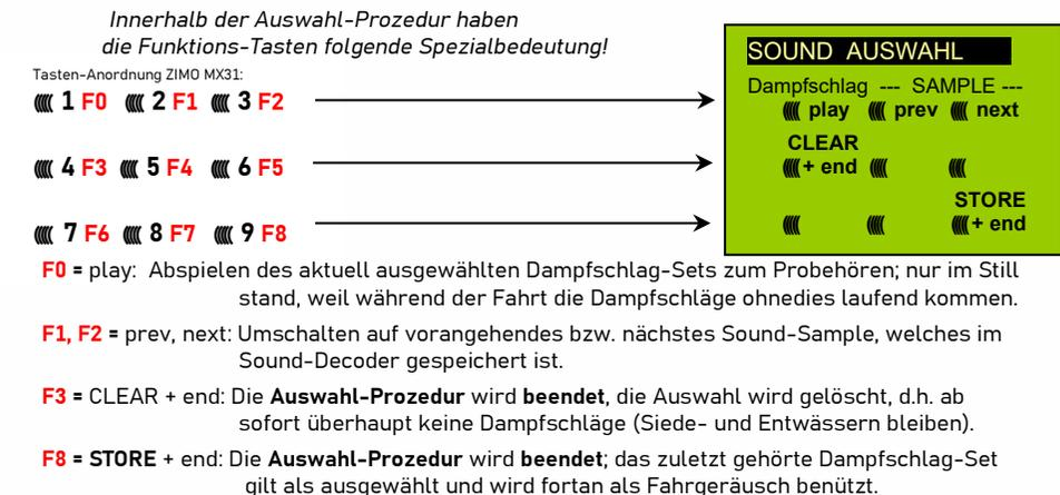
Die **Auswahl-Prozedur** wird ebenfalls **beendet**, wenn irgendein anderer Programmiervorgang durchgeführt wird (z. B. **CV #300 = 0**). Auch durch Unterbrechung der Stromversorgung. In diesen Fällen gilt wieder die **„alte“ Zuordnung**. Eine solche „Zwangs-Beendigung“ wird übrigens auch dazu gebraucht, wenn zur „alten“ Zuordnung zurückgekehrt werden soll, ohne dieses „alte“ Dampfschlag-Set wieder suchen zu müssen.
