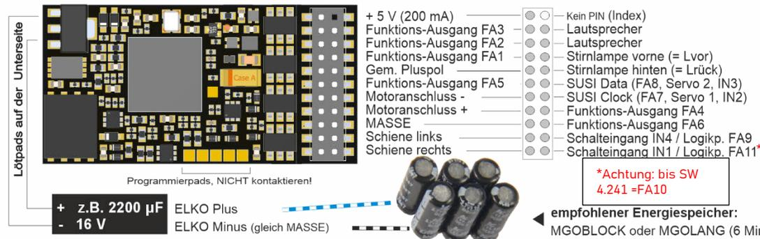
**MS440C, MS440D** Unterseite, mit 21MTC . SOUND
