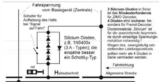
geschaltet. Der unterschiedliche Spannungsabfall erzeugt eine Asymmetrie von ca. 1 bis 2 V. Die Einbaurichtung der Dioden bestimmt die Fahrtrichtung, in welcher der Signalstopp eintreten soll.
