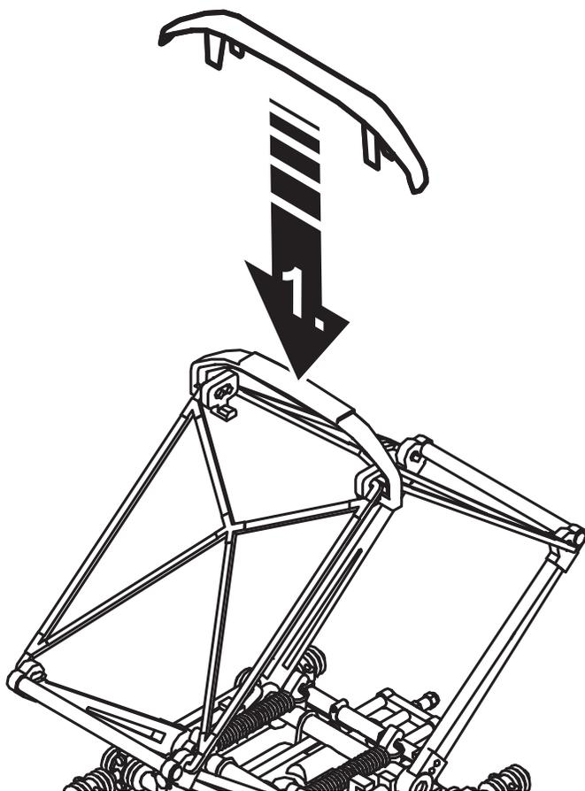
La circulation sous caténaire posée en zig-zag ou en courbe nécessite obligatoirement la pose d'un frotteur plus large sur les pantographes (fourni).
