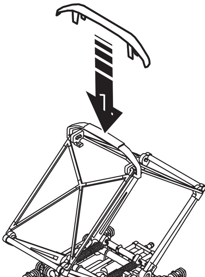
Vid körning med luftledning som är monterad i sick-sack eller i böjda sektioner måste en bredare kontaktskena (bifogad) monteras på takströmvtagaren.
