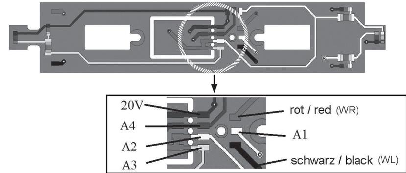
Funktionsdecoder-Anschluß am Beispiel des Beiwagen VT98 # 40680:
