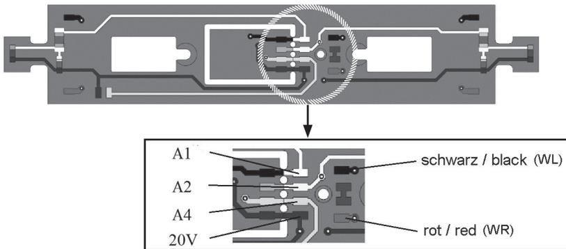
Funktionsdecoder-Anschluß am Beispiel des Beiwagen VT98 # 40680:
