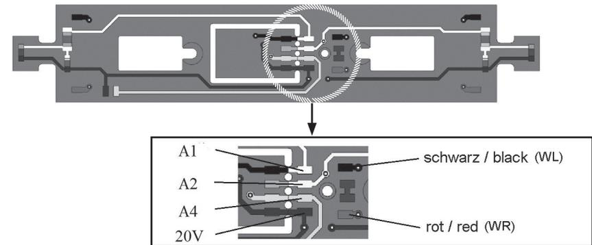
Funktionsdecoder-Anschluß am Beispiel des Beiwagen VT98 # 40681:
