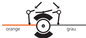
Abbildung 22: 5-poliger Märklin® Hochleistungsmotor
