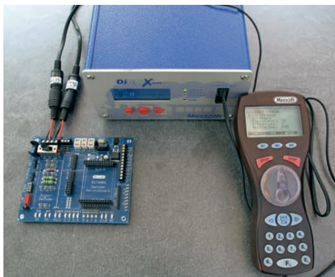
Das Testboard wird am Gleisspannungsausgang einer Dimax-Zentrale und am Programmiergleis Ausgang angeschlossen.
