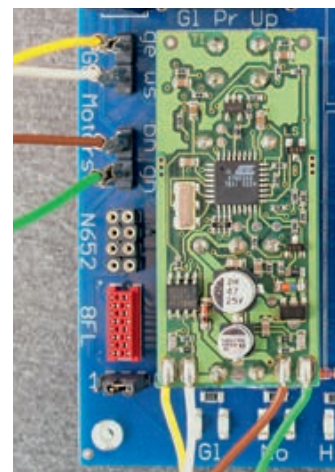
Direct-Decoder-schnittstelle mit LGB 55021 Decoder. Die Kabel sind, um Kurzschlüsse zu vermeiden, zusätzlich den Farben entsprechend auf „LGB Motorst.“ aufgesteckt.
