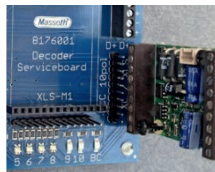
Massoth XL/XLS-Decoder werden hochkant auf die Stiftleiste gesetzt.
