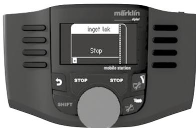
Ställ loket på spåret, tryck därefter på stoppknappen och vänta. Efter en liten stund syns den blinkande texten „mfx“ på displayen. Detta visar att loket anslutits och att lokets data läses in.
