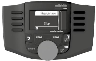
Collocate la Vostra locomotiva sul binario, dopodiché vogliate premere sul tasto Stop per dare la via libera all'impianto di binari. Dopo un breve intervallo appare mfx sul visore e lampeggia. In questo modo viene mostrato che la locomotiva viene riconosciuta ed i suoi dati acquisiti.
