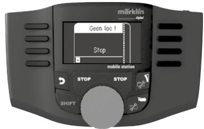
Plaats nu uw locomotief op de rails en daarna drukt u op de toets Stop om de spoorbaan in te schakelen. Na korte tijd verschijnt mfx op het display en knippert. Hiermee wordt aangegeven,
