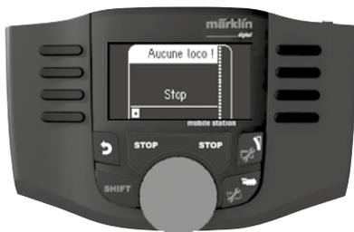
Posez la locomotive sur la voie, appuyez sur la touche Stop pour valider le circuit. Après quelques secondes, l'affichage indique mfx et clignote. Cela indique que le système a détecté la locomotive et que les données peuvent être lues.
