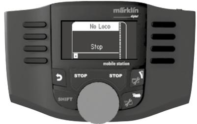
Coloque la locomotora en la vía y, a continuación, pulse la tecla Stop para habilitar la instalación de vías. Al cabo de poco tiempo aparece mfx en el display y destella. De este modo se indica que se ha identificado la locomotora y que se están leyendo los datos de ésta.
