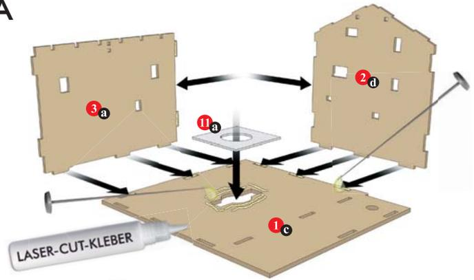
Wenig Klebstoff verwenden. Bei filigranen Teilen den Klebstoff z.B. mit einer Stecknadel o.ä. auftragen.
