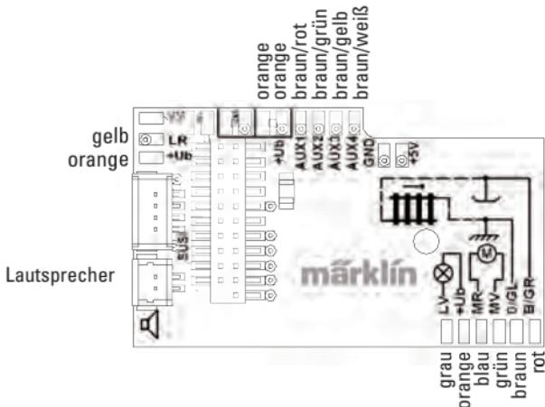
Decoder einstecken, auf richtigen Einbau achten. Modell noch ohne Gehäuse auf dem Programmiergleis einer Prüfung unterziehen. Wenn der Decoder einwandfrei arbeitet, kann das Gehäuse montiert werden.
