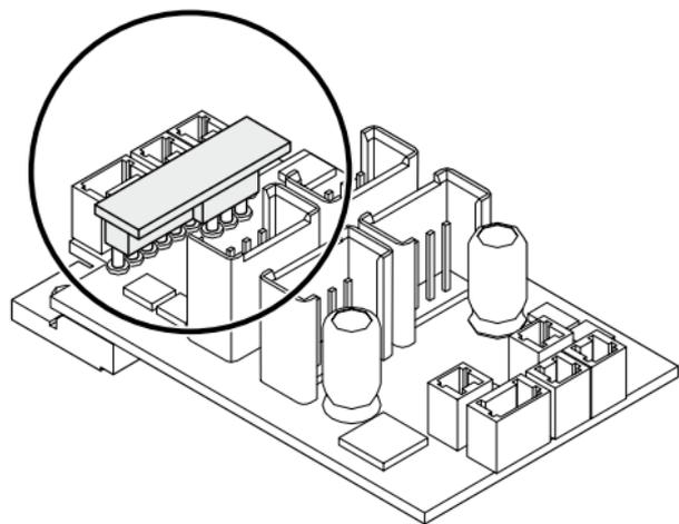
*Bild 1: Decoder in den Adapter einstecken*
