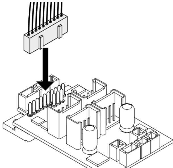
**Bild 3: Adapter an der Schnittstelle einstecken**
