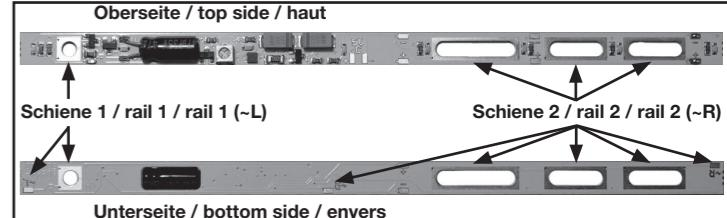
Die Litzen an der Leiterplatte an den Lötpunkten Schiene 1 (~L) und Schiene 2 (~R) anlöten.
