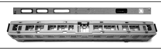
Bei der direkten Beleuchtung wird die Leiterplatte so eingebaut, dass die LED's nach unten ins Wageninnere zeigen. Leiterplatte gegebenenfalls mit doppelseitigem Klebeband fixieren. **Darauf achten, dass die elektronischen Bauelemente auf der Leiterplatte nicht einge克莱mt oder beschädigt werden!** Gegebenenfalls die Kunststoffstege an Wagenkasten oder Inneneinrichtung ausschneiden.
