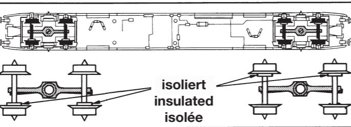
Radsätze müssen mit ihren grauen Isolierbüchsen entsprechend Abbildung eingesetzt sein (Kurzschlussgefahr).
