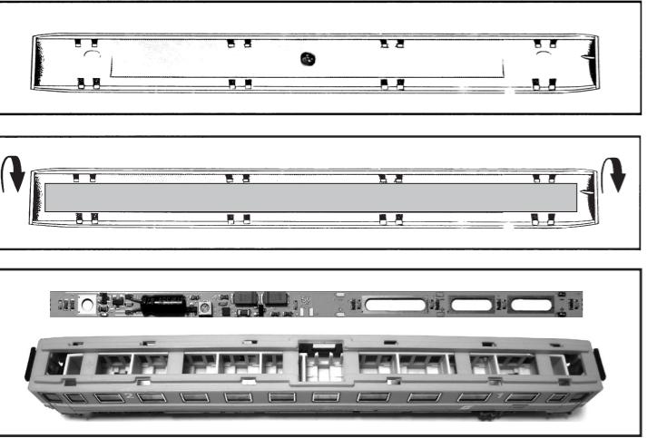
Bei der indirekten Beleuchtung wird die Leiterplatte so eingebaut, dass die LED's nach oben zum Dach zeigen. Leiterplatte gegebenenfalls mit doppelseitigem Klebeband fixieren. Spritzguss im Dach abschneiden. In das Dach wird einer der beiliegenden Reflektorstreifen geklebt. Die Alufolie ergibt eine kühle Farbtemperatur (Leuchstofflampen), die Kupferfolie ergibt eine warme Farbtemperatur (Gaslampe / Glühlampe).
