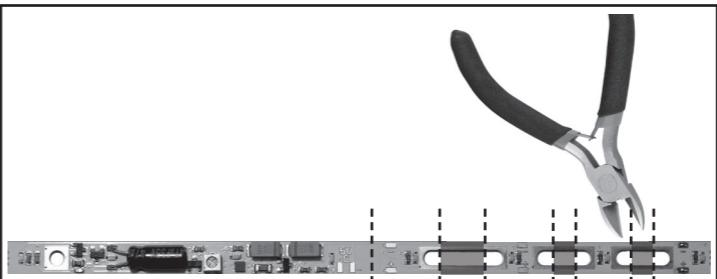
Wird die Leiterplatte in kürzere Wagen eingebaut, muss sie an den vorgesehenen Stellen gekürzt werden. Mit einem Seitenschneider oder einer Schere schneidet man die Leiterplatte auf die benötigte Länge. Der Einbau erfolgt auf die im Folgenden beschriebene Weise.
