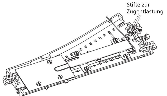
Zur Zugentlastung die 3 Drähte um die 3 Stifte legen. Zur seitlichen Herausführung der Anschlüsse ist die Aussparung in der Bettung zu nutzen.
