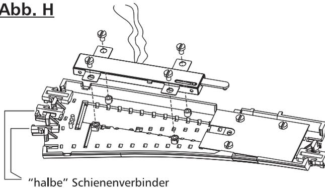
Den Antrieb auf die 4 Schraubdomen aufsetzen. Dabei muss der Zapfen des Schaltschiebers in das Loch des Stellschiebers einrasten. Den Antrieb mit den 4 Schrauben befestigen.
