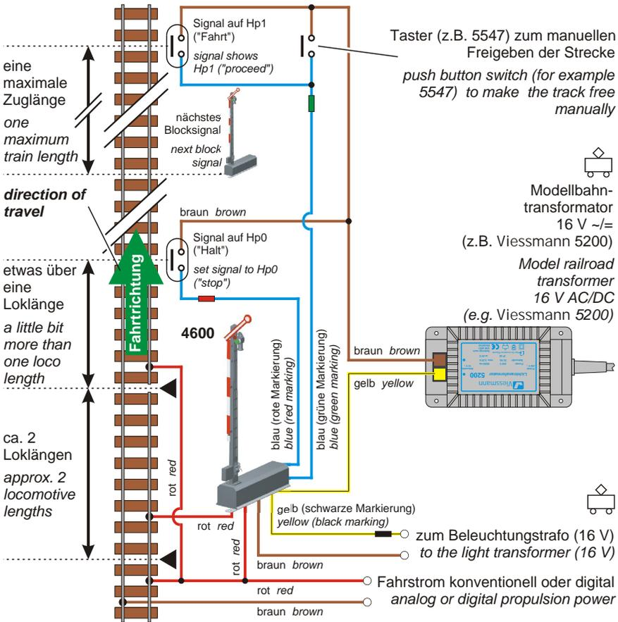
ale Position etwas mehr als eine (maximale) Zuglänge hinter dem *nächsten* Blocksignal.
