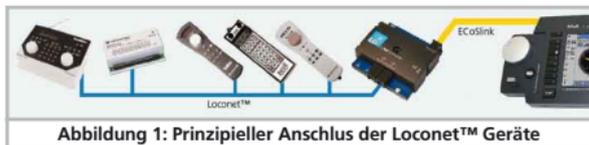
Abbildung 1: Prinzipieller Anschluss der LocoNet™ Geräte
