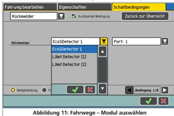
In Abb. 11 sind neben einem „echten“ ECoSDetector noch zwei virtuelle Rückmeldebausteine („L.Net Detector [1]“ und L.Net Detector [2]) zu finden. Die Zahl in eckigen Klammern entspricht den virtuellen Rückmeldebausteinen (im Beispiel also die LocoNet™ Rückmelder 1- 16 sowie 17 – 32). Denken Sie daran, dass in der Auswahlliste „Port“ jeweils die Nummern 1 bis 16 auswählbar sind. Port Nummer 1 des „L.Net Detector [2]“ entspricht daher der LocoNet™ Rückmeldenummer 17.
