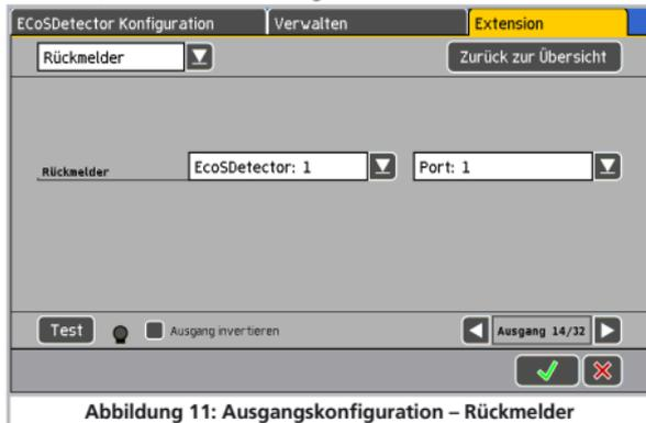
Sie können noch festlegen, ob der Ausgang invertiert werden soll. Dies ist hilfreich, wenn eine Gleisbesetzmeldung zu einer abgeschalteten LED führen soll. Wählen Sie hierzu „Ausgang invertieren“ aus.
