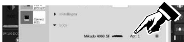
**!** Het wijzigen van het omzet-adres wordt niet in de loc-decoder opgeslagen!
