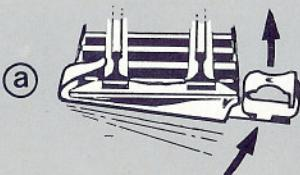
Anschlußklemme in gezeigter Weise von unten einsetzen. Das Kontaktblech muß Druckkontakt mit dem Schienenuß bekommen.
