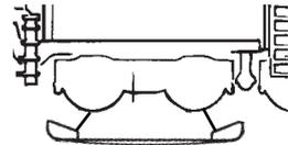
Zum Aus- und Einbau beachten Sie bitte auch die entsprechende Lokanleitung. Dieser Schischleifer passt an alle neueren ROCO-Lokomotiven. Bei der Umrüstung von älteren Lokomotiven und Fremdfabrikaten wenden Sie sich bitte an Ihren Fachhändler.
