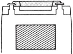
Am Fahrzeugboden eine ebene Klebefläche schaffen. Bei manchen Fahrzeugtypen (meist Drehgestellfahrzeuge) kann es notwendig sein, den Fahrzeugboden entsprechend auszusägen. Die Kulissenmechanik, auf dem Fahrzeugboden bzw. Chassis bzw. Beschwerung mit einem handelsüblichen 2-Komponenten-Kleber (z.B. UHU-plus Sofortfest) befestigen.
