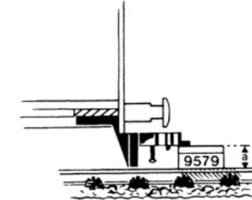
Einbauhöhe a der Kulissenmechanik entsprechend Abbildung überprüfen. Dazu den PROFI-Kupplungskopf 9570 auf die Kulissenmechanik aufstecken und Kupplungshöhe mit der Einstell-Lehre 9579 grob überprüfen (Feineinstellung wird später vorgenommen).
