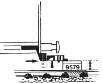
Mit der Einstell-Lehre 9579 genaue Kupplungshöhe einstellen. Den Aufnahmesteg für den PROFI-Kupplungskopf 9570 an der Kulissenmechanik kürzen, so daß ein Entkuppeln über einem Entkupplungsgleis möglich ist.
