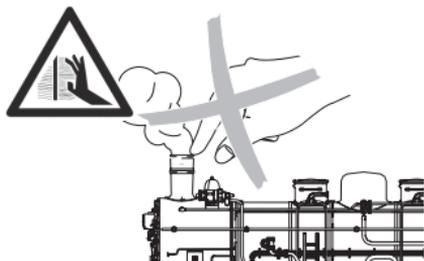
**Achtung:** der Kamin der Lok wird bei Betrieb des Rauchgenerators (mit oder ohne Rauchöl) heiß. Verbrennungsgefahr.
