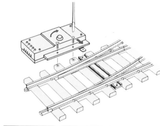
Das Einsetzen des Antriebs wird erleichtert, wenn der Stellschieber „A“ unter der Abdeckung vorsteht. Er ist in den Endstellungen verriegelt und kann nur mit dem Stellknopf „B“ verschoben werden.
