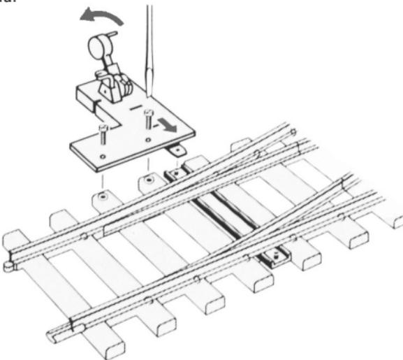
Wird der elektromagnetische Antrieb 5625 – rechts oder links – (an die Weiche 5965, 5966, 5976 oder 5977) angeschraubt, muss vorher der Handstellhebel entfernt werden.
